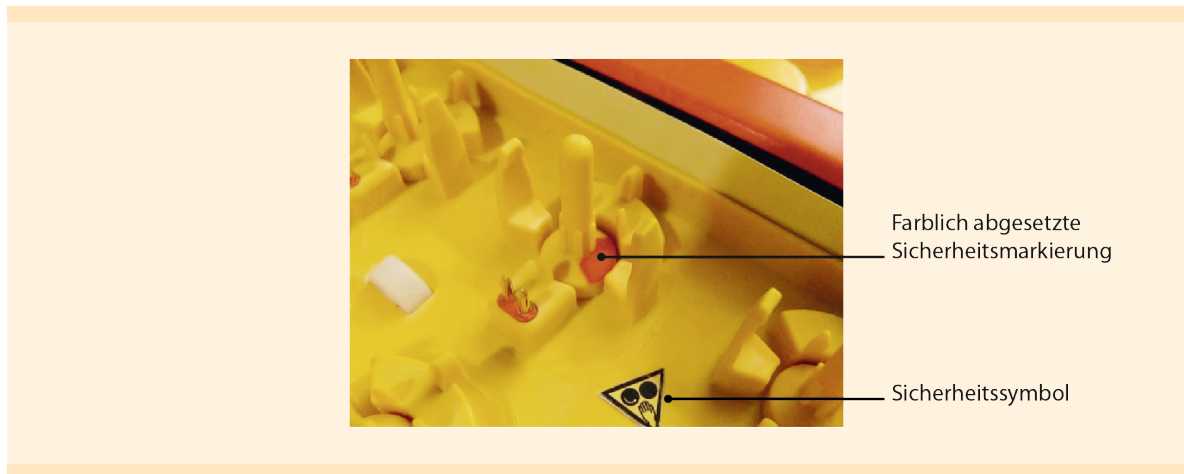
Figure 1: Sicherheitssymbol auf dem Einsatz des gentleMACS Octo Dissociator with Heaters. Die Sleeves tragen eine farblich abgesetzte Sicherheitsmarkierung.
