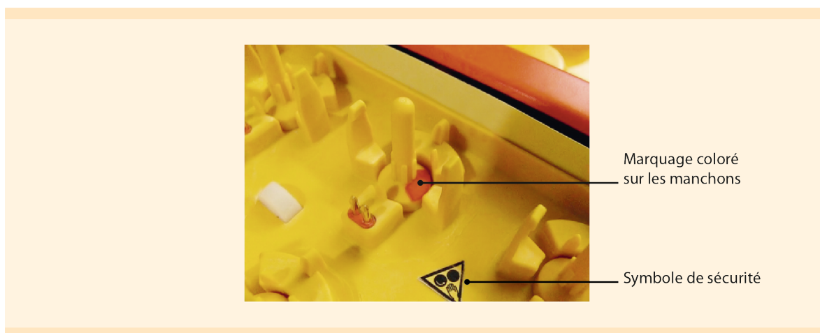
Figure 1: Symbole de sécurité sur la fosse du gentleMACS Octo Dissociator with Heaters. Les manchons bénéficient d'un marquage coloré.
